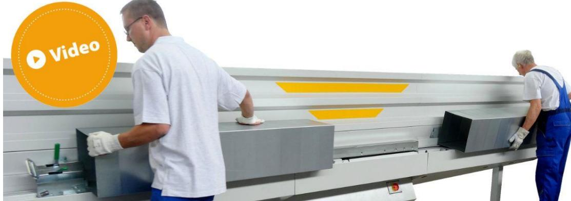
Als de luchtkanalen super dicht moeten zijn, injecteert de SealJet een afdichtmiddel in de naadverbinding tijdens het arbeidsproces. Een sensorsysteem start en stopt het injectieproces. Het afdichtmiddel is temperatuurbestendig, biedt corrosiebescherming en voldoet aan de hygiëne eisen. De SealJet kan achteraf worden ingebouwd in bestaande RAS DuctZippers in L- en V-vorm.
