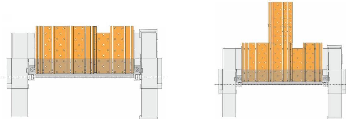
De UpDown vouwmaschine RAS XLTbend is beschikbaar in 2 versies. De werk lengte is niet alleen geschikt voor metalen cassettes met een groot oppervlak, maar ook voor kleinere complexe buigonderdelen waarvoor meerdere gereedschapsstations langs de buiglijn nodig zijn.
