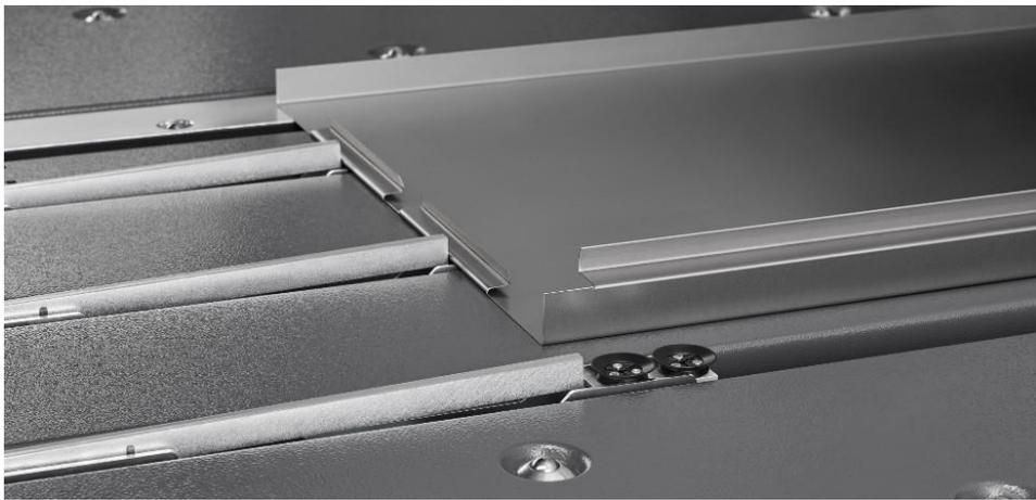
Het modulaire stopconcept biedt de keuze tussen een rechthoekige stop tot 1550 mm stopdiepte. De centraal verlengde T-stop tot 3250 mm (4100 mm) is ideaal voor grote oppervlakken en biedt de beste buigresultaten. Le concept de butée modulaire offre le choix entre une butée rectangulaire jusqu'à 1550 mm de profondeur. La butée en T étendue centralement jusqu'à 3250 mm (4100 mm) est idéale pour les grandes surfaces et offre les meilleurs résultats de flexion.
