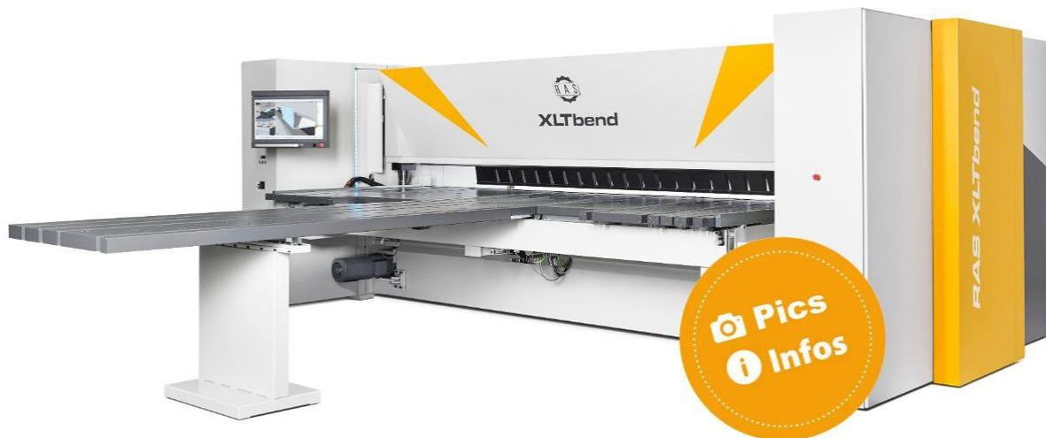
Met de UpDown-technologie hoeven de buigonderdelen niet te worden gedraaid bij het veranderen van de buigrichting. De eenvoudige en snelle werking zorgt voor korte cyclustijden en lage eenheidskosten.
