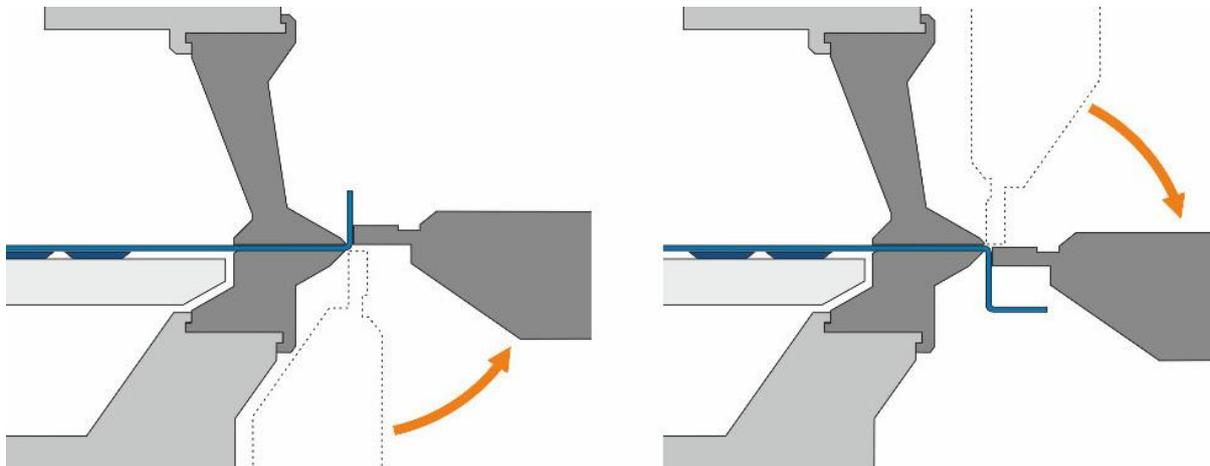
Stabiele aanslagvingers positioneren het werkstuk op de buiglijn. Tegelijkertijd houden zuignappen het gebogen deel tegen de aanslagvingers. Hierdoor zijn complete buigvolgorden mogelijk zonder tussenkomst van de operator. Omdat de plaat bij de stop in het buigproces blijft, kan een enkele persoon grote en zware, maar ook dunne en knikgevoelige metalen onderdelen en profielen alleen buigen.
