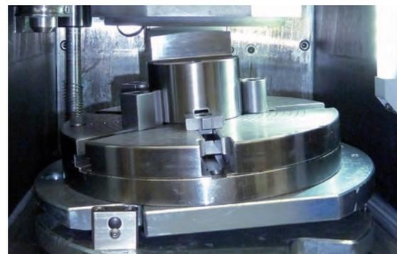
Table rotative avec angle réglable – jusqu'à 12°
