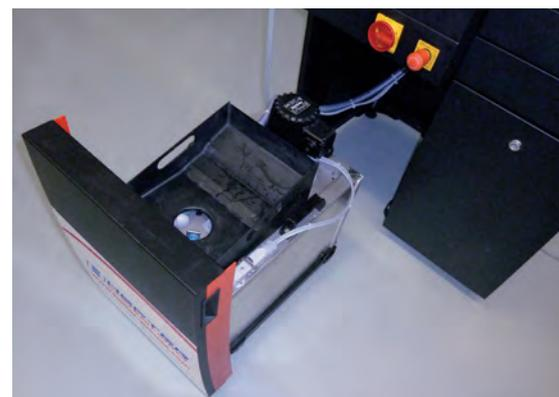
Le réservoir du liquide de refroidissement est équipé de roues facilitant ainsi les travaux de remplissage et de nettoyage.
